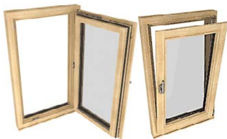
Joonis 2.3. Pöördkaldavatava raamiga sissepoole avanev aken
