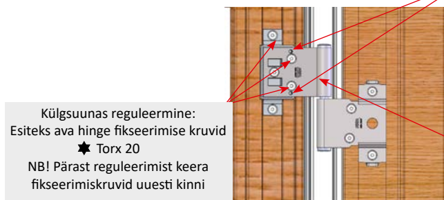
Joonis 7.2. SW17 akna pöördhinge reguleerimine
