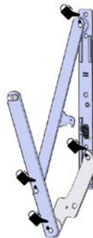
Joonis 7.11. SW17 altpöördatav aken. Hingede reguleerimine ja õlitamine
